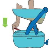
Realice el primer retrolavado después de un día de uso: Verifique que ambos depósitos contengan por lo menos un poco de agua. Luego presione la palanca roja de retrolavado hasta abajo, suavemente, sosténgala por 15 segundos y suéltela.
