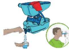
En cuanto el depósito para agua purificada contenga agua, ya puede servirse agua purificada a través de la llave de salida.
