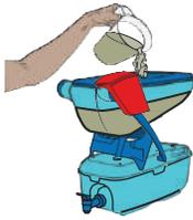
Llene el depósito para agua prefiltrada a través del prefiltro de malla.
