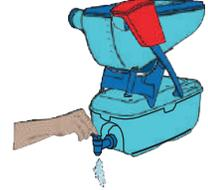
Deseche completamente la primera descarga de agua que se acumule en el depósito para agua purificada.
